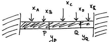
Belastning av balk. Belastningarna  $(x_A, x_B, x_c, x_d, x_E)$  ger utböjningar  $(y_P, y_Q)$
