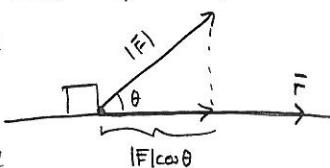
Om vi släpar föremålet vektoru  $\bar{r}$ , dvs.  $|\bar{r}|$  långt, så blir arbetet
